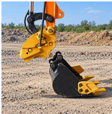
ENGATE RÁPIDO HIDRÁULICO Comando na cabina Troca sem sair da máquina
