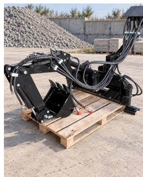
RETROESCAVADORA 1 350 mm Valas e fundações
