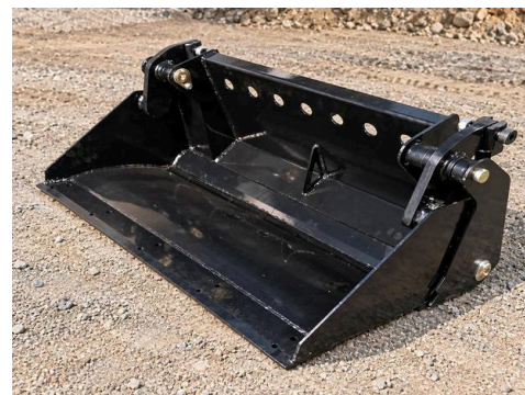
BALDE 4-EM-1 0,14 m³ · 110 kg Carregar, nivelar, agarrar
